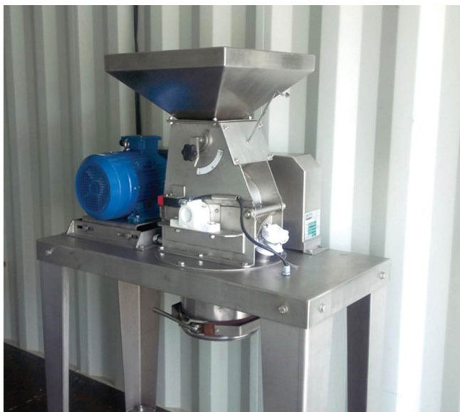
Vue d'ensemble du broyeur à marteaux
